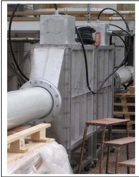
图 6, 5000 m 3 /h 移动式等离子体净化器
