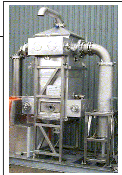
图 2, 30 kW 短脉冲电源及等离子体反应器
