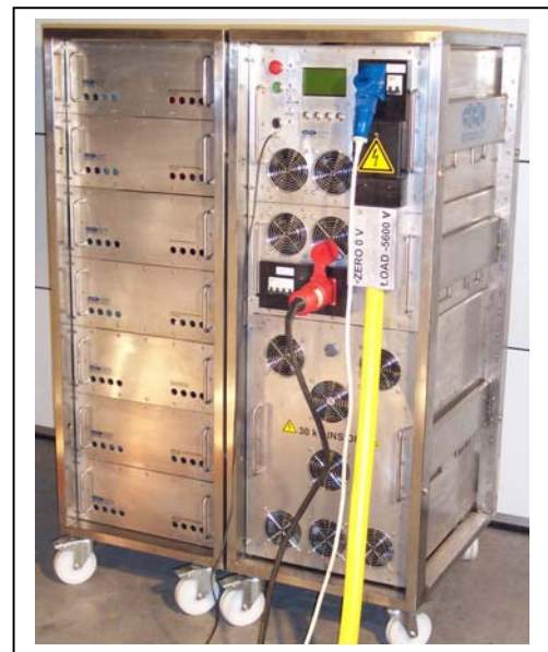
图 8, 10-20 kJ/pulse & 20-45 kA 全固体开关电源
